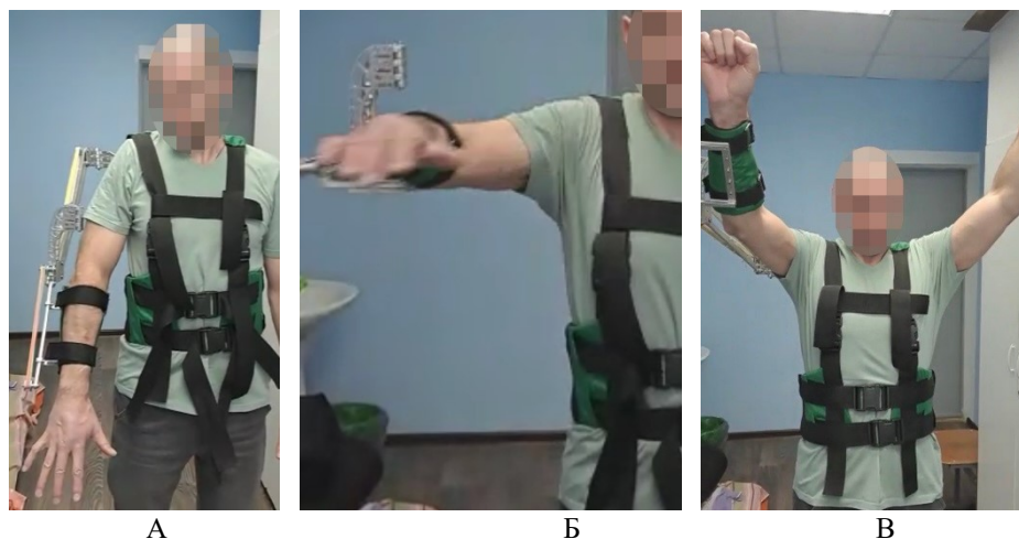
Рис. 3. Экзоскелет ЭКЗАР34 на правой верхней конечности (первая примерка): А – внешний вид экзоскелета, Б – отведение правого плеча, В – сгибание правого плеча Fig. 3. Exoskeleton EXAR34 on the right upper limb (first fitting): A – appearance of the exoskeleton, Б – abduction of the right shoulder, В – flexion of the right shoulder
